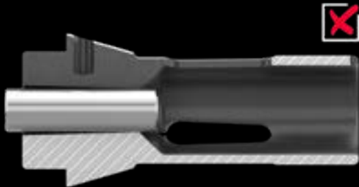
Darstellung einer punktuellen Ringspannung im hinteren Bereich der Spannfläche
