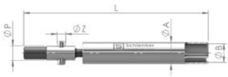
A Außen-Ø B Schnittstelle Vorschubstange P Passung-Ø Z Querbohrung-Ø L Gesamtlänge
