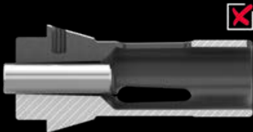
Darstellung einer punktuellen Ringspannung im vorderen Bereich der Spannfläche
